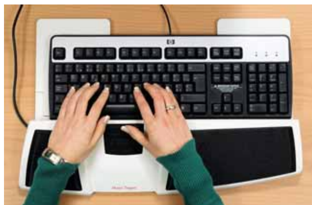
Bild 17: Diese spezielle Maus liegt vor der Tastatur und lässt sich mit beiden Daumen bedienen.
